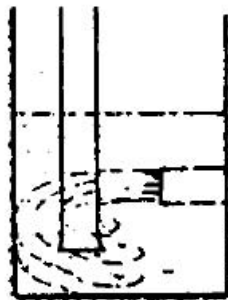
Schéma 7 Un cloisonnement permet d'éviter la rotation de l'eau dans le puis (voir schéma).
