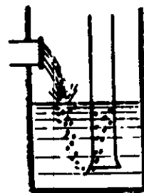
Fig. 6(b) La tubería de alimentación se extiende al interior del sumidero para impedir la introducción de aire al agua.
